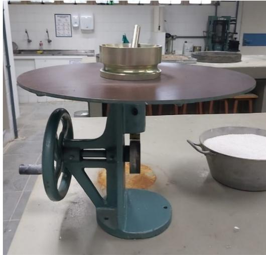
Imagem 08: Aparelho para o Flow Table Test.
