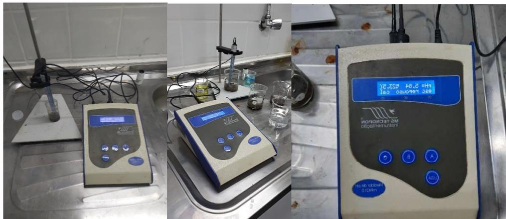
Imagem 01: *pHmetro* digital realizando a análise do pH da amostra.
