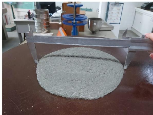
Imagem 09: Medida do diâmetro da base do tronco de cone de argamassa.
