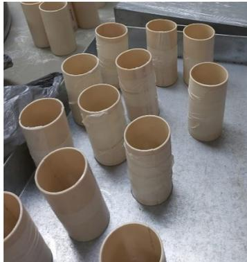
Imagem 10: Moldes de 50 mm de diâmetro por 100 mm de altura.
